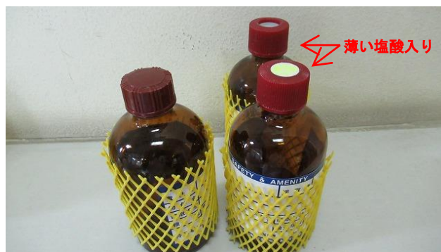
② 左側はハロ酢酸、ホルムアルデヒド用 右側のゴム栓付は、消毒副生成物・揮発性有機化合物用(黄色のシールを貼付したものもあります。)保存液(薄い塩酸)が少量入っていますので取り扱いにご注意。
