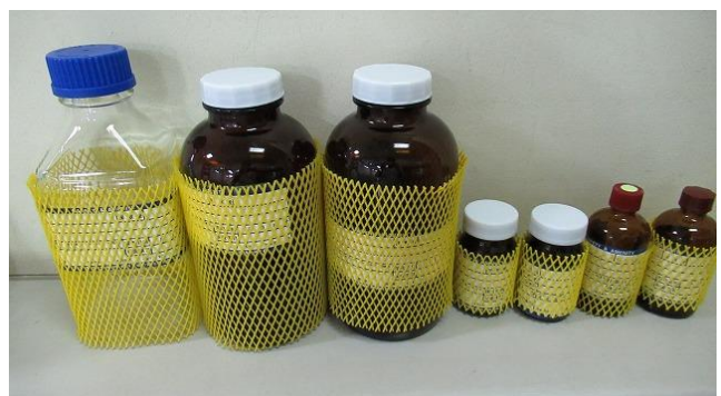
⑥ ガラス瓶には破損防止のため 保護ネットが被せてあります。
