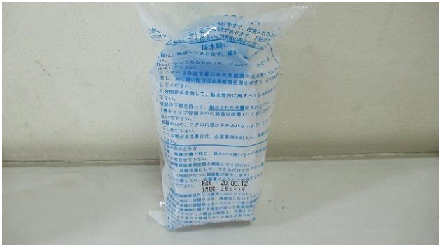
① 200mL 細菌検査用採水容器 (袋内は滅菌してあります)
